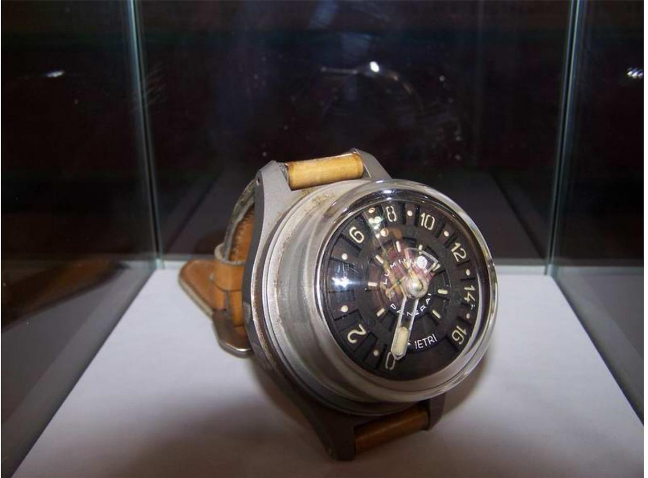
Ed ecco un "vecchio profondimetro" a membrana con indicazione a lancetta e quadrante al luminor fisso, siamo negli anni 70 e le novita' non sono finite perche' seguiranno altri modelli con referenza PSP861 con indicazione fissa al traser e quadrante mobile con scala incisa al trizio.
